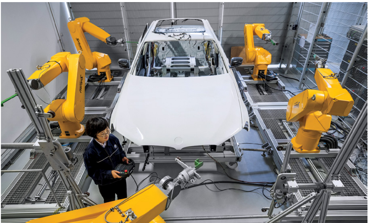
研发中心的车门及襟翼试验台。
